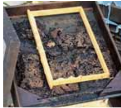
2. Dazu legt man die Waben in den Kasten, tut den Deckel drauf und lässt die Sonne draufscheinen. Das Wachs wird durch die Wärme flüssig und fließt in einen Behälter.
