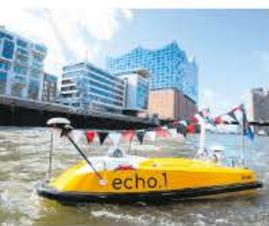
Bis zu sechs Stunden kann diese Drohne im Hamburger Hafen herumfahren. Sie misst, wie tief es an verschiedenen Stellen im Wasser ist. Hier siehst du sie bei ihrer Einweihung. Foto: C. Charisius, dpa
