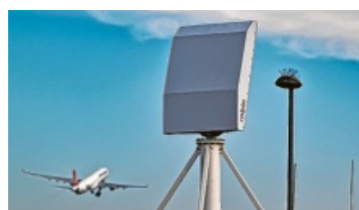
Das neue Radarsystem kann Vogelschwärme in der Nähe des Berliner Flughafens erfassen. Foto: Patrick Pleul, dpa
